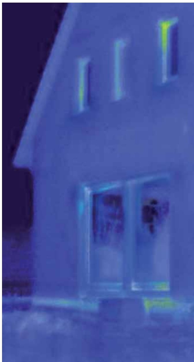
Po obnovi: uporaba dvižno drsnih vrat GENEEO bistveno zmanjša toplotne izgube
