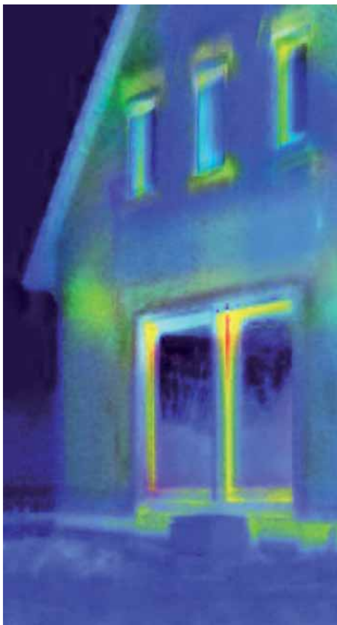
Pred obnovo: na sliki so predstavljene toplotne izgube
